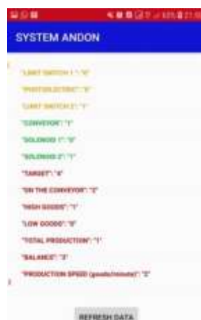
Gambar 8. Tampilan Data Andon pada Smartphone Android
