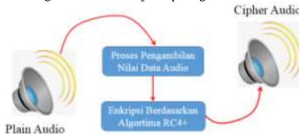
Gambar 1. Skema Pengamanan Audio Berdasarkan Algoritma RC4+
